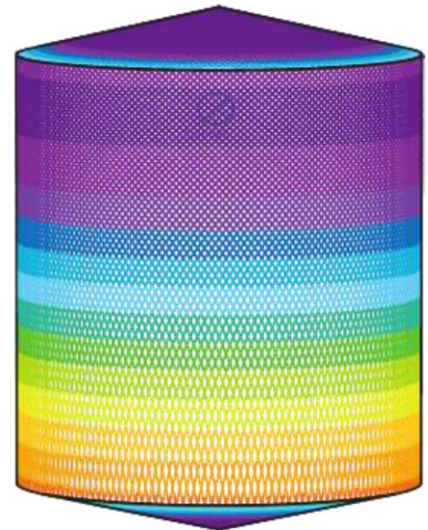
D4.6m H5.5m, Toftejorg TJ40G, 4 x ø7.3 mm, 時間 = 16 min., 水消費量 = 5600 l
