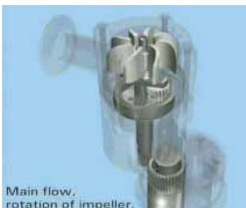
インペラシャフトは、プラネットギアとかみ合っており、そのアウトプットシャフトがダウンパイプとクリーナーユニットを回転させます。プラネットギアはT1とT2という2種類のギアCCからなっています。プラネットホイールとギアリングを除けばこの2種類の部品には全く同じものが使用されています。
