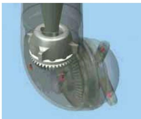
マシンへ流入する洗浄液は、ベースハウジングとダウンパイプを通してインレットからクリーナーヘッドに入り、ノズルから出てくる仕組みになっています。ダウンパイプのアウターチューブは、そのチューブ内にあるボールベアリングと一緒に固定式シャフト上で回転できる状態で作られています。作動装置は垂直軸の周りをアウターチューブとクリーナーユニットで回転させます。固定式シャフトとクリーナーヘッドの上にあるベベルギアを通して、クリーナーヘッドとノズルが同時に平行軸の周りを回転します。それによりノズルが動き、タンク内を360°ジェットが噴出され、規定パターンで洗浄を行います。
