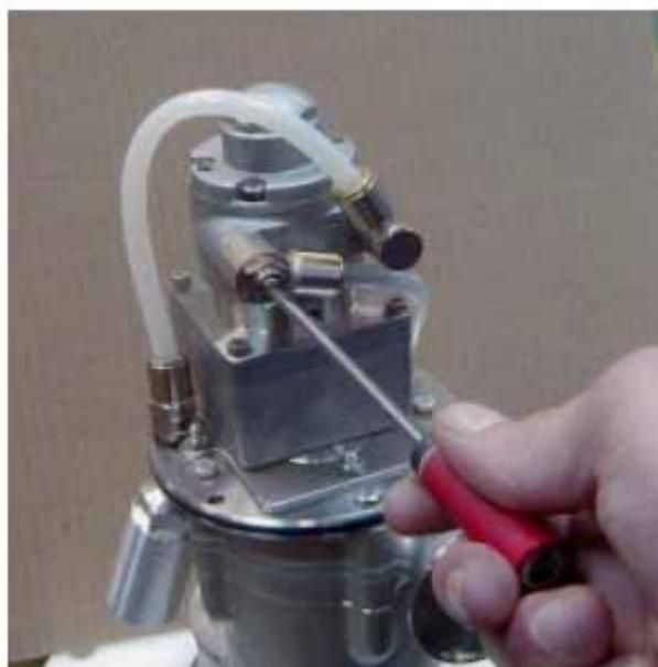
洗浄液が入っていない状態でも大体のスピードは調整することは出来ませんが、圧力下での洗浄液での洗浄を行う際の回転速度は多少減速します。厳密なスピード調整を行うためにはタンクにマシンが取り付けられ、閉まった状態のタンクの中を規定された圧力で洗浄液を入れて作動させることです。
