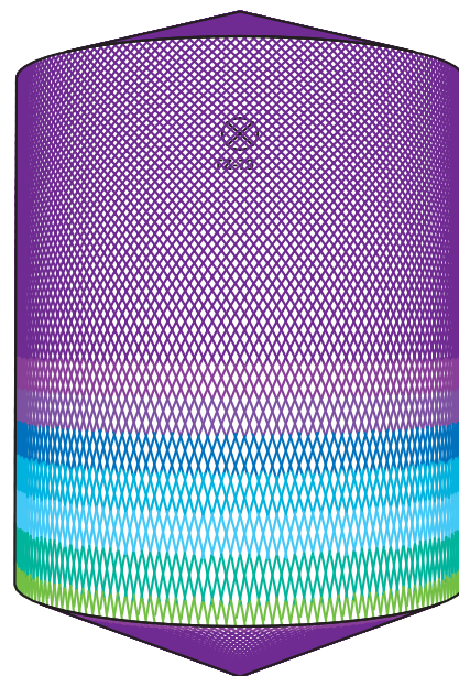
D8m H10m, Toftejorg MJ50, 4 x ø10 mm, 0 % 時間 = 23.3 分、水消費量 = 10868 l
