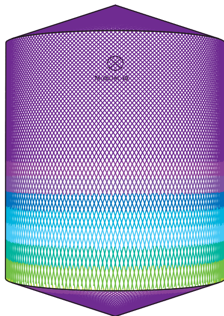
D5m H6m、Toftejorg MultiJet40、4 x ø6 mm、100% 時間 = 18.2 分、水消費量 = 3760 l
