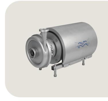
LKH ポンプは、標準でシングルメカニカルシャフトシールを装備していますが、シングルフラッシュまたはダブルメカニカルシャフトシールも利用可能です。スプリングとワッシャーが外接式のシャフトシールを採用しているため、メンテナンスが早く、簡単で、安価に行えます。また、バランスに優れた構造は、不意の圧力ショック時にシールが開いてしまうリスクを最小限に抑えます。
