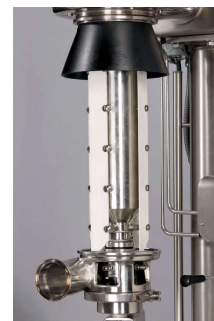
保守を容易にする油圧式昇降装置とブレードガイド
