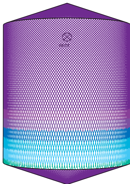
D5m H6m、Toftejorg TZ-74 自動洗浄型、4 x ø7 mm、0% 時間 = 15.3 分、水消費 = 4,853 l (1,282 ガロン)
